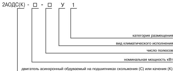
Электродвигатели асинхронные двухскоростные с короткозамкнутым ротором типа 2АОД предназначены для привода механизмов с тяжелыми условиями пуска (насосов, вентиляторов, дымососов и других механизмов).
