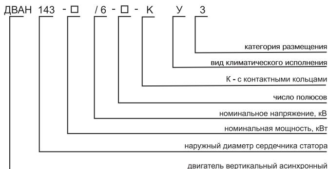
Двигатели асинхронные вертикальные серии ДВАН трехфазного тока, предназначены для привода вертикальных гидравлических насосов.
