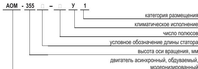
Электродвигатели асинхронные трехфазные с короткозамкнутым ротором типа АОМ-355 предназначены для привода различных механизмов, не требующих регулирования частоты вращения (насосы, вентиляторы, дымососы и т. д.). Двигатели предназначены для работы от сети переменного тока частотой 50 Гц напряжением 3000 В, 6000 В.
