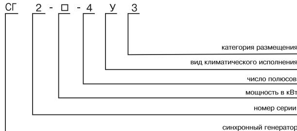
Генератор синхронный типа СГ2 предназначен для работы в составе дизель - генератора в качестве источника трехфазного переменного тока частотой 50 Гц.
