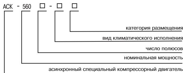
Электродвигатели асинхронные специализированные компрессорные типа АСК предназначены для привода стационарных компрессоров. Двигатели предназначены для работы от сети переменного тока частотой 50 Гц напряжением 380 В.
