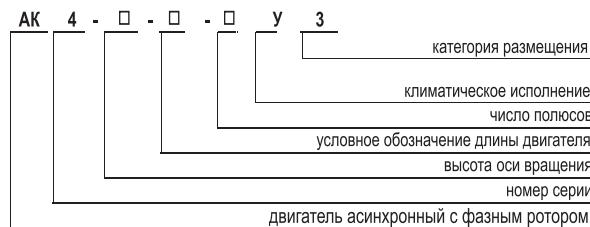
Электродвигатели асинхронные трехфазные с фазным ротором типа АК4 предназначены для привода механизмов, требующих регулирования частоты вращения, а также для привода механизмов с тяжелыми условиями пуска. Двигатели предназначены для работы от сети переменного тока частотой 50 Гц напряжением 6000 В.
