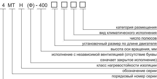
Электродвигатели асинхронные трехфазные с фазным ротором типа 4МТН-400 предназначены для работы на подъемно-транспортных механизмах и в электроприводе металлургических агрегатов. Двигатели предназначены для работы от сети переменного тока частотой 50 Гц напряжением 380 В и другие напряжения.
