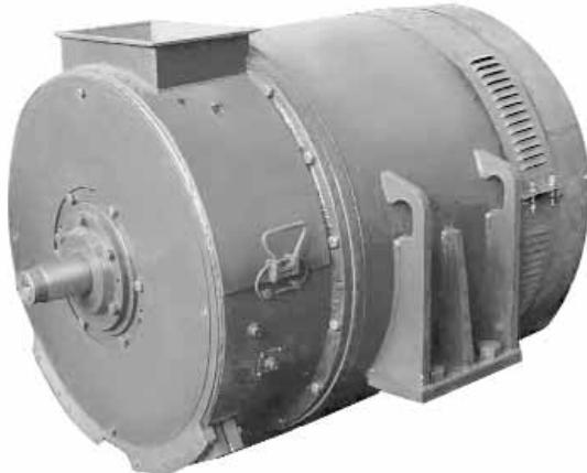
**Синхронный тяговый генератор типа СГТ-1400 со статической системой возбуждения, предназначен для питания через выпрямительную установку двух тяговых электродвигателей карьерного самосвала.**
