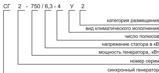
Генераторы синхронные типа СГ2-750/6,3 и СГ2-1000/6,3 с бесщечточной системой возбуждения предназначены для работы в составе турбогенератора, в качестве источника трехфазного переменного тока частотой 50 Гц напряжением 6300 В. Генераторы поставляются в комплекте с тиристорным возбудительным устройством (ТВУ).
