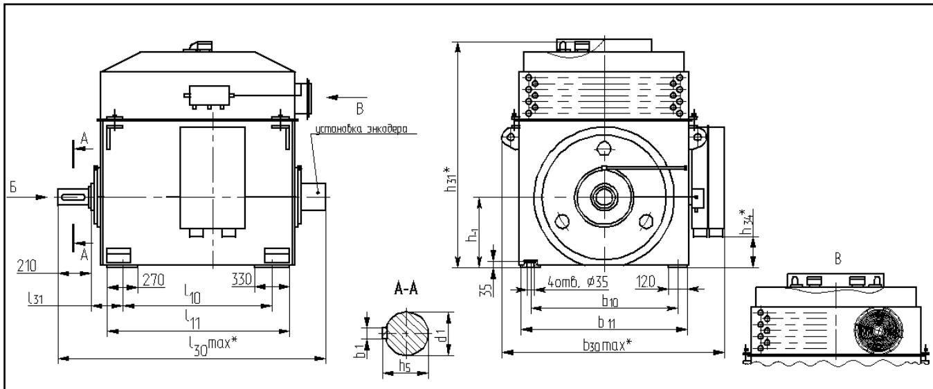
**Габаритные, установочные, присоединительные размеры и масса двигателей АДПМ**
