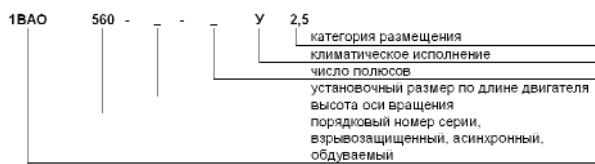
Электродвигатель асинхронный вертикальный серии 1ВАО-560 IM3011 (аналог ВАОВ2-630М-4).
