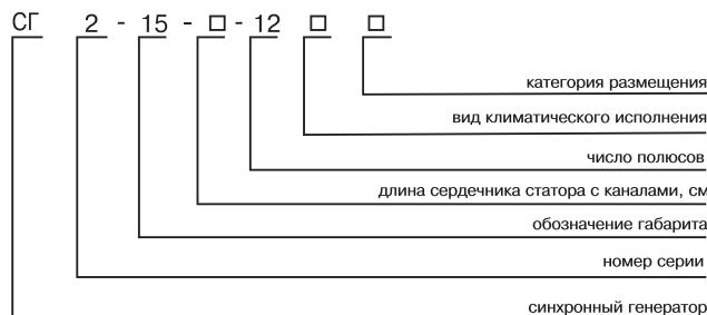
Генераторы синхронные трехфазные типа СГ2-15-46-12 и СГ2-15-40-12 со статической системой возбуждения предназначены для работы в качестве источника трехфазного переменного тока частотой 50 Гц в стационарных установках. Приводом генератора может служить дизель, паро- и гидротурбина или электродвигатель. Генераторы рассчитаны на номинальное напряжение 400 В.
