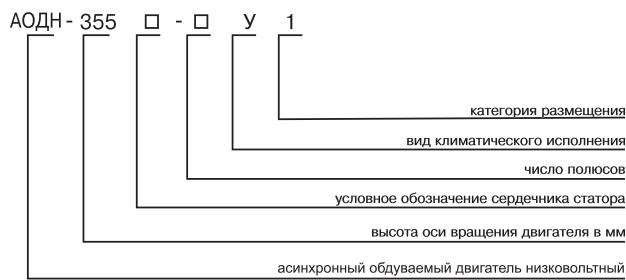
Электродвигатели асинхронные трехфазные с короткозамкнутым ротором типа АОДН предназначены для привода различных механизмов, не требующих регулирования частоты вращения (насосов, вентиляторов, дымососов и т.д.)
