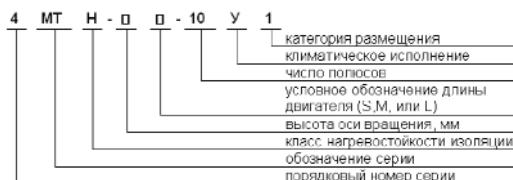
Двигатели 4МТН 280, 315 предназначены для работы на подъемно-транспортных механизмах, в электроприводе механизмов металлургических агрегатов в условиях повышенной влажности, запыленности и вибрации.
