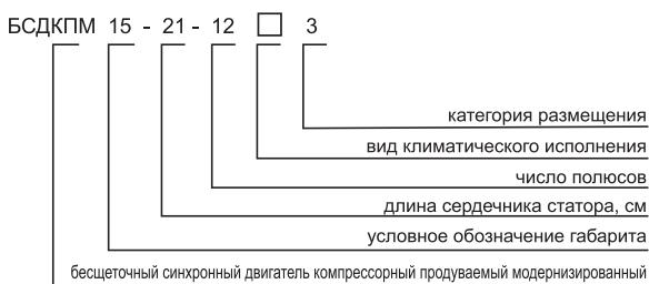
Электродвигатели синхронные компрессорные типа БСДКПМ с цифровой системой возбуждения КОСУР 122 предназначены для привода газовых угловых компрессоров на базе 5ГП во взрывоопасных зонах. Двигатели предназначены для работы от сети переменного тока частотой 50 Гц напряжением 380 В, 400 В, 415 В, а также частотой 60 Гц напряжением 380 В и 440 В.
