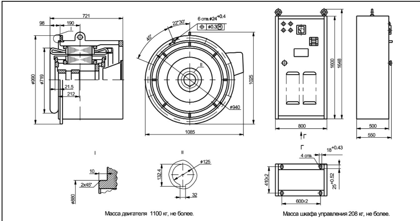
**Габаритные, установочные, присоединительные размеры и масса двигателя АСК-560 и шкафа управления**
