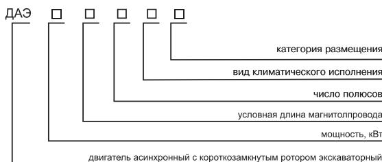
Электродвигатели асинхронные трехфазного тока с короткозамкнутым ротором типа ДАЭ-250-4 предназначены для комплектации пяти машинных преобразовательных агрегатов экскаваторов.
