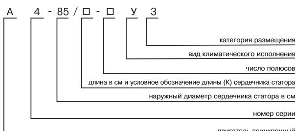
Электродвигатели асинхронные трехфазные с короткозамкнутым ротором серии А4 предназначены для привода механизмов, не требующих регулирования частоты вращения (насосы, вентиляторы, дымососы и др.).
