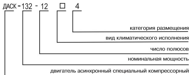
**Электродвигатели асинхронные трехфазные с короткозамкнутым ротором типа ДАСК-132 предназначены для привода поршневых компрессоров.** Двигатели предназначены для работы от сети переменного тока частотой 50 Гц напряжением 380 В.
