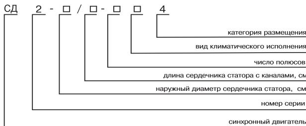
Электродвигатели синхронные трехфазные серии СД2 с цифровой системой возбуждения КОСУР 103 предназначены для привода механизмов, не требующих регулирования частоты вращения (насосы, вентиляторы и др.). Двигатели предназначены для работы от сети переменного тока частотой 50 Гц. Номинальное напряжение двигателей 6000 В или 3000 В, коэффициент мощности (при опережающем токе) 0,9.
