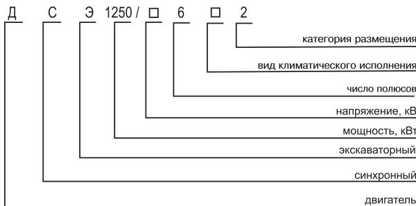
Двигатели синхронные серии ДСЭ-1250 трехфазного тока, специального назначения, предназначены для привода генераторов постоянного тока, которые питают приводные двигатели основных рабочих механизмов экскаваторов.
