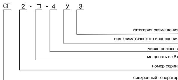
Генераторы синхронные типа СГ2-500, СГ2-600, СГ2-750 с бесщечточной системой возбуждения предназначены для работы в составе турбогенератора в качестве источника трехфазного переменного тока частотой 50 Гц напряжением 400 В. Генераторы обеспечивают работу на индивидуальную сеть, на сеть большой мощности, могут быть использованы для работы с приводом от дизеля.
