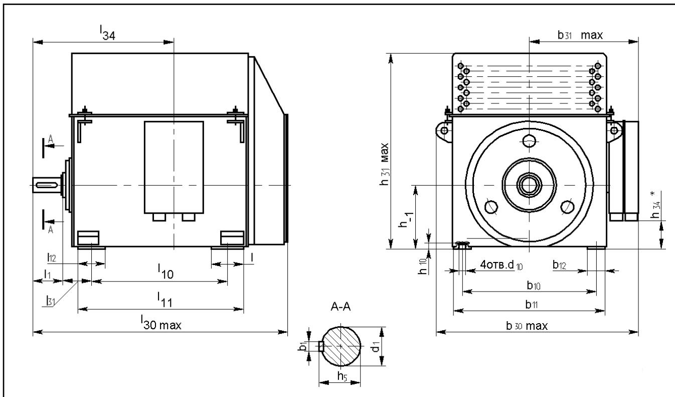
**Габаритные, установочные, присоединительные размеры и масса двигателей серии АДЧР**
