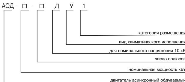
Электродвигатели асинхронные трехфазные с короткозамкнутым ротором типа АОД предназначены для привода механизмов, не требующих регулирования частоты вращения (насосы, вентиляторы, дымососы и др.).
