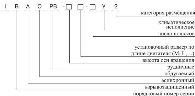
Электродвигатели трехфазные асинхронные взрывозащищенные с короткозамкнутым ротором низковольтные типа 1ВАОРВ предназначены для установки в подземных выработках шахт, рудников и их надземных строениях, опасных по рудничному газу и/или пыли, для привода стационарных машин и механизмов. Маркировка по взрывозащите - РВExdI.
