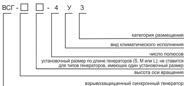
**Взрывозащищенные синхронные генераторы типа ВСГ с бесщечточной системой возбуждения предназначены для использования в качестве автономного источника трехфазного переменного тока частотой 50 Гц напряжением 400 В.**
