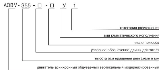
Электродвигатели асинхронные трехфазные вертикальные с короткозамкнутым ротором типа АОВМ предназначены для привода механизмов, не требующих регулирования частоты вращения (насосы, вентиляторов, дымососы и др.).
