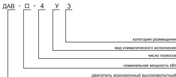
**Электродвигатели асинхронные трехфазные с короткозамкнутым ротором серии ΔΑΒ предназначены для привода механизмов, не требующих регулирования частоты вращения (насосы, вентиляторы, дымососы и др.).**
