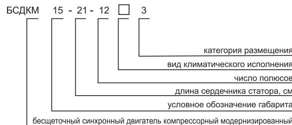
Электродвигатели синхронные трехфазные компрессорные типа БСДКМ с цифровой системой возбуждения КОСУР 122 предназначены для привода воздушных поршневых компрессоров на базе 5ВП. Двигатели предназначены для работы от сети переменного тока частотой 50 Гц напряжением 380 В, 400 В, 415 В, а также частотой 60 Гц напряжением 380 В и 440 В.
