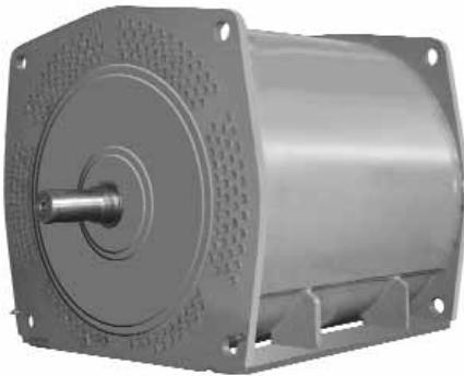
**Электродвигатели трехфазные асинхронные взрывозащищенные высоковольтные с короткозамкнутым ротором типа 1ВАО-560 предназначены для привода стационарных машин и механизмов, работающих во взрывоопасных зонах класса 1 по ГОСТ Р 51330.9. Двигатели должны иметь взрывобезопасный уровень взрывозащиты с видом взрывозащиты "взрывонепроницаемая оболочка", и маркировкой по взрывозащите 1ExdIIIBT4 или PBExdI по ГОСТ Р 51330.0-99.**
