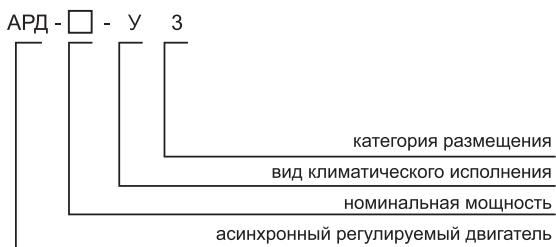
**Электродвигатели асинхронные трехфазные с фазным ротором типа АРД** предназначены для привода дымососов, воздуходувок, конвейеров и других механизмов, требующих ограниченного диапазона регулирования частоты вращения.
