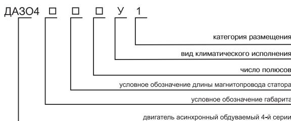
Электродвигатели асинхронные двигатели трёхфазного тока с короткозамкнутым ротором типа ДАЗО4-12, ДАЗО4-13 предназначены для привода различных механизмов, не требующих регулирования частоты вращения (насосов, вентиляторов, дымососов и т.п.)
