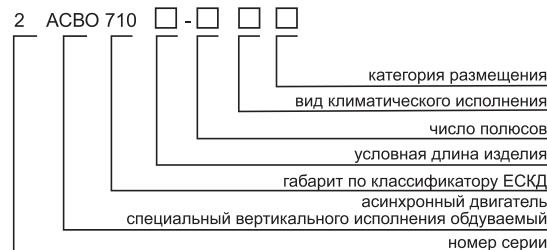
Электродвигатели асинхронные трехфазные с короткозамкнутым ротором типа 2АСВО предназначены для безредукторного привода вентиляторов градирен.
