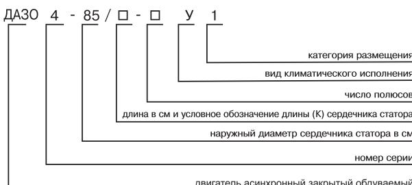
Электродвигатели асинхронные трехфазные с короткозамкнутым ротором серии ДАЗО4 предназначены для привода механизмов, не требующих регулирования частоты вращения (насосы, вентиляторы, дымососы и др.) Двигатели предназначены для работы от сети переменного тока частотой 50 Гц напряжением 3000 В, 6000 В и 10000 В.
