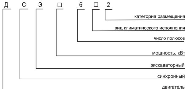
Двигатели синхронные серии ДСЭ-750, 630 трехфазного тока, специального назначения, предназначены для привода генераторов постоянного тока, которые питают приводные двигатели основных механизмов экскаваторов.
