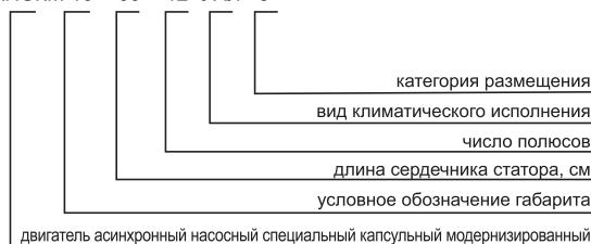
Электродвигатели асинхронные трехфазные с короткозамкнутым ротором типа АНСКМ предназначены для привода погружного насоса.
