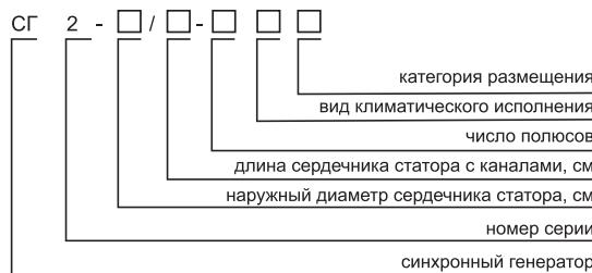
Генераторы синхронные трехфазные серии СГ2 со статической системой возбуждения предназначены для работы в качестве источника трехфазного переменного тока частотой 50 Гц в стационарных установках. Приводом генератора может служить дизель, паро- и гидротурбина или электродвигатель.
