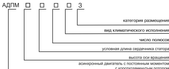
Электродвигатели асинхронные типа АДПМ трёхфазного тока с короткозамкнутым ротором предназначены для работы в составе частотно-регулируемых приводов механизмов с постоянным моментом на валу, равным развиваемому при работе с синхронной частотой вращения  $\pi$  и номинальной мощностью  $P_{2 \text{ ном}}$ , в диапазоне частот вращения  $250 \div \pi$  об/мин.
