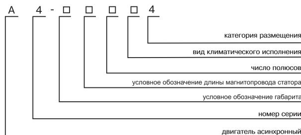
Электродвигатели асинхронные двигатели трёхфазного тока с короткозамкнутым ротором типа А 4 -12, А4-13 предназначены для привода различных механизмов, не требующих регулирования частоты вращения (насосов, вентиляторов, дымососов и т.п.)
