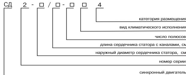
Электродвигатели синхронные трехфазные серии СД2 с цифровой системой возбуждения КОСУР 103 предназначены для привода механизмов, не требующих регулирования частоты вращения (насосы, вентиляторы и др.).
