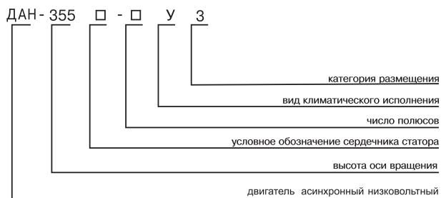
**Электродвигатель асинхронный трехфазный с короткозамкнутым ротором серии ДАН** предназначен для привода механизмов, не требующих регулирования частоты вращения (насосы, вентиляторы, дымососы и др.).
