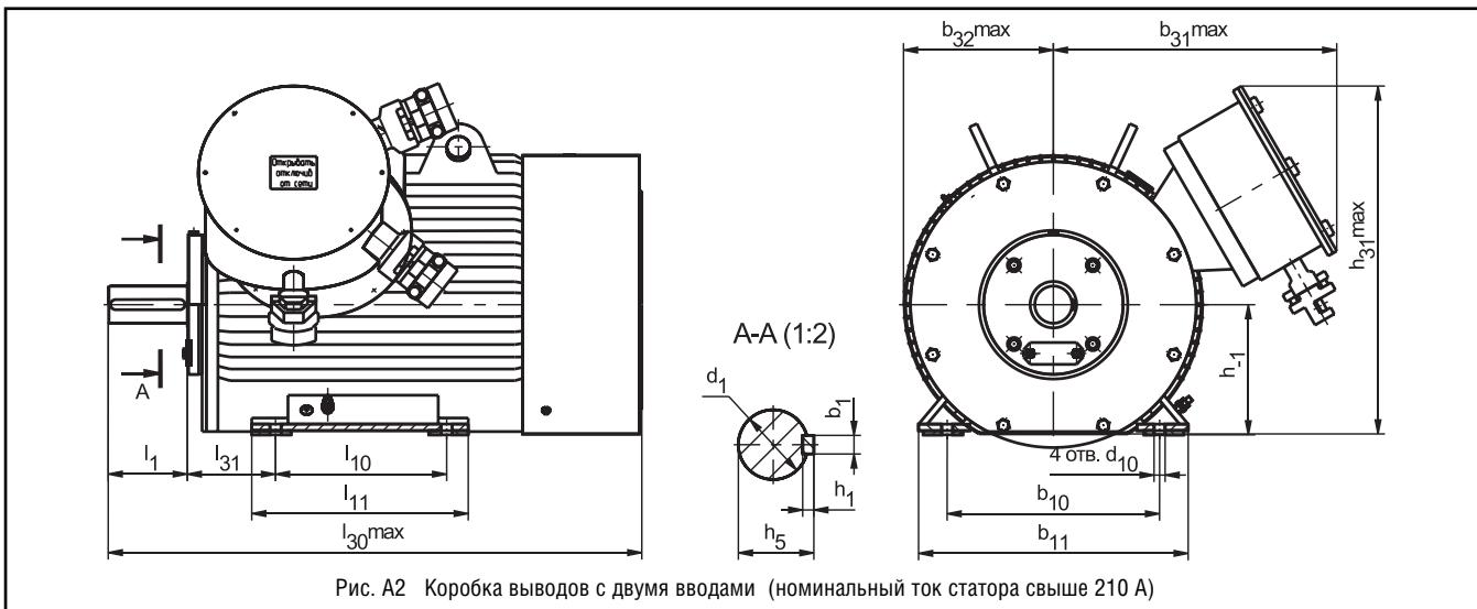
Рис. А2 Коробка выводов с двумя вводами (номинальный ток статора свыше 210 А)
